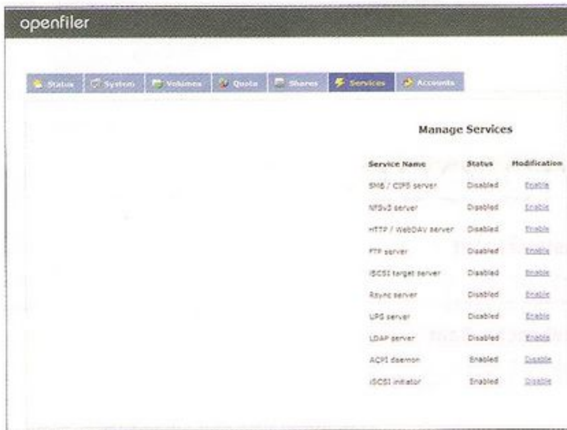
Afbeelding 3. Als je een iSCSI SAN wilt configureren, moet je niet vergeten de iSCSI-target-service aan te zetten
